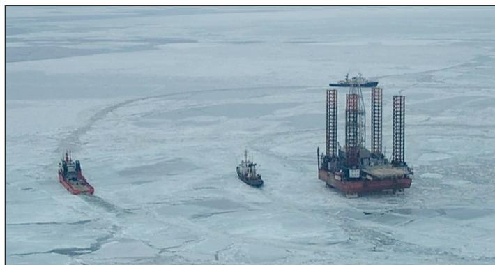
Рис. 1. Реальная ледовая обстановка в декабре 2002 г. Азовское море: СПБУ пр. 1540 в ледовом плену
