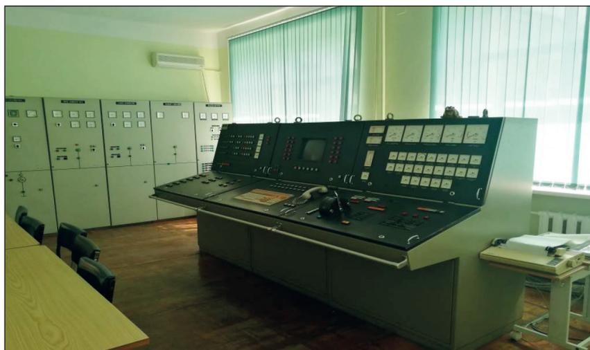
Рис. 2. Пост управления тренажёра типа «DPS 100-GFCA»
