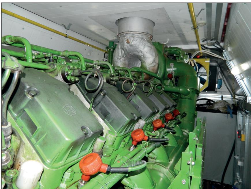
Рис. 2. Газонефтяной дизель 12 ГДЧН 26/26 семейства Д49
