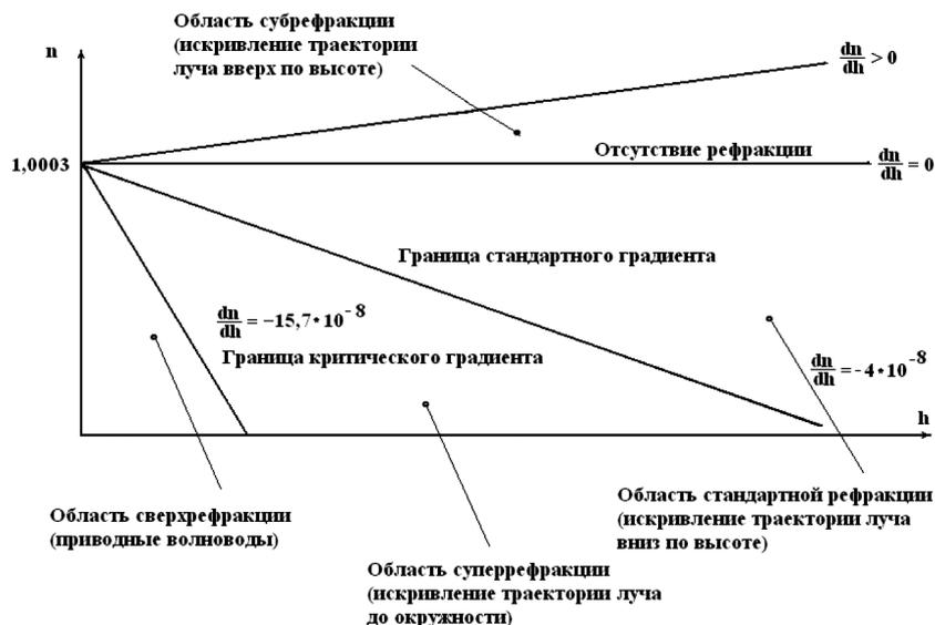
Рис. 4. Области субрефракции, стандартной рефракции, суперрефракции и сверхрефракции в зависимости от изменения показателя преломления  $n$  с высотой  $h$  в нижних слоях атмосферы Земли
