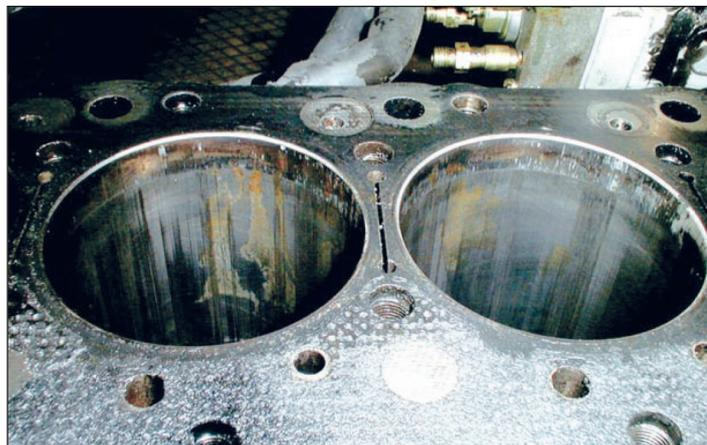
Рис. 1. Следы задиров на юбке поршня (а) и зеркале (б) цилиндра
