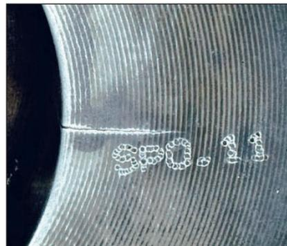
Рис. 4. Трещины на кромке камеры сгорания: а — общий вид; б — увеличенный фрагмент
