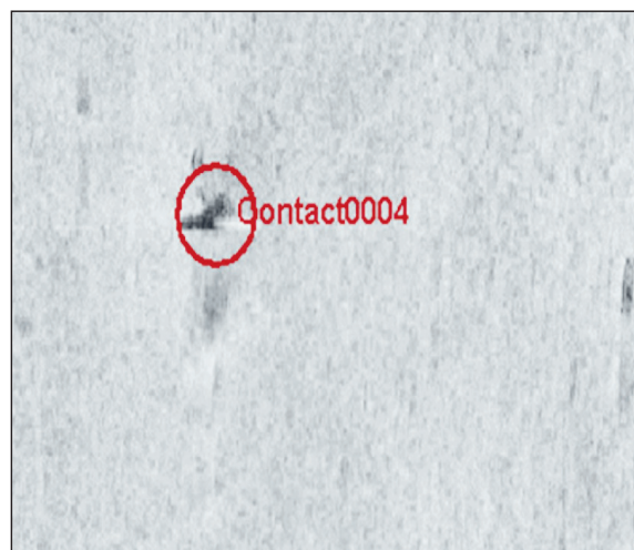
Рис. 4. Изображения металлической трубы, полученные с помощью телеуправляемых необитаемых подводных аппаратов (а) и интерферометрического гидролокатора бокового обзора (б)
