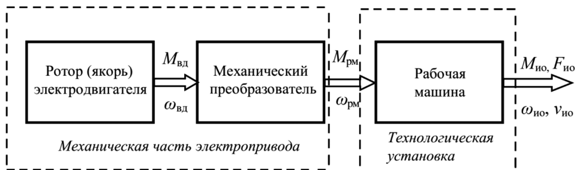
Рис. 2. Структурная схема механической системы электропривода
