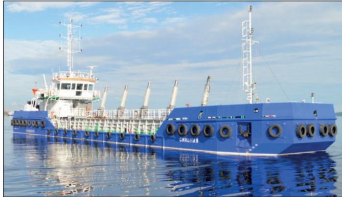
Рис. 1. Самоходная грунтоотвозная шаланда «Сильная», пр. НВ600
