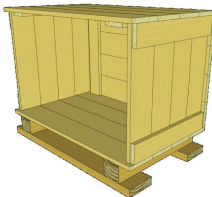
Рис. 3. Пример формирования крейт-модуля на поддоне
