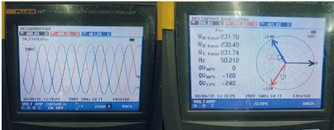
Рис. 7. Видеокadres измерений комплексом Fluke 435 электрических параметров судовой сети в процессе проведения экспериментальных исследований
