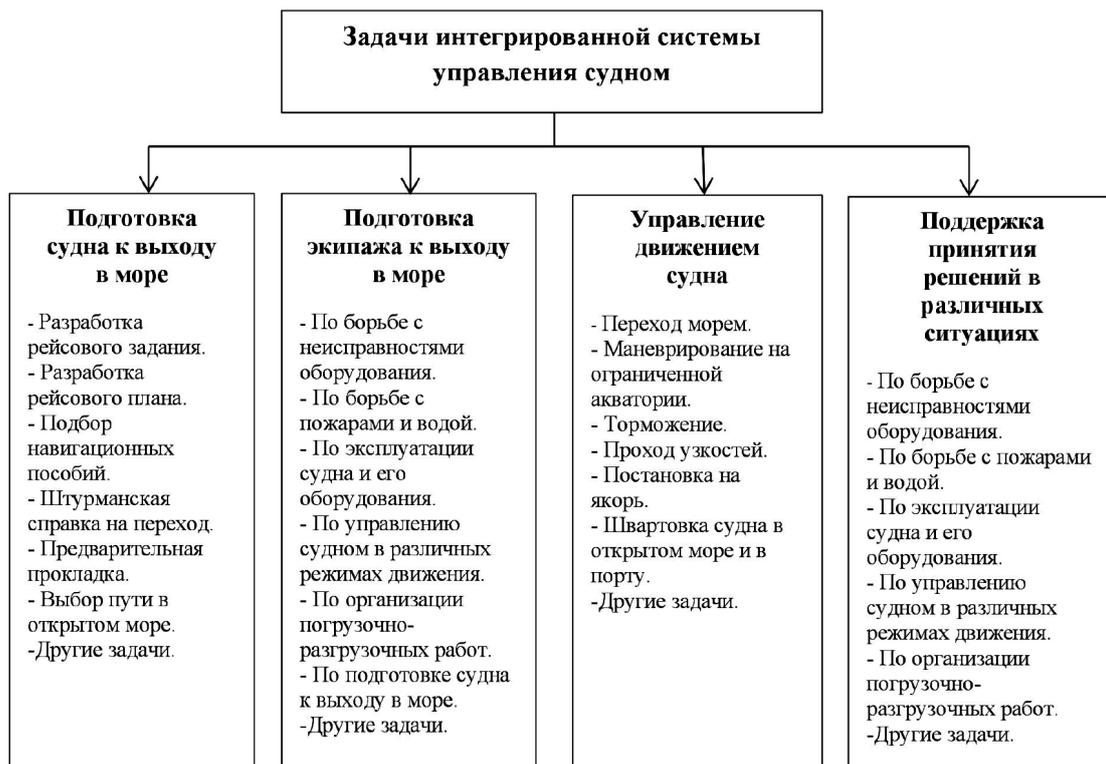
Рис. 1. Задачи, решаемые интегрированной системой управления судном
