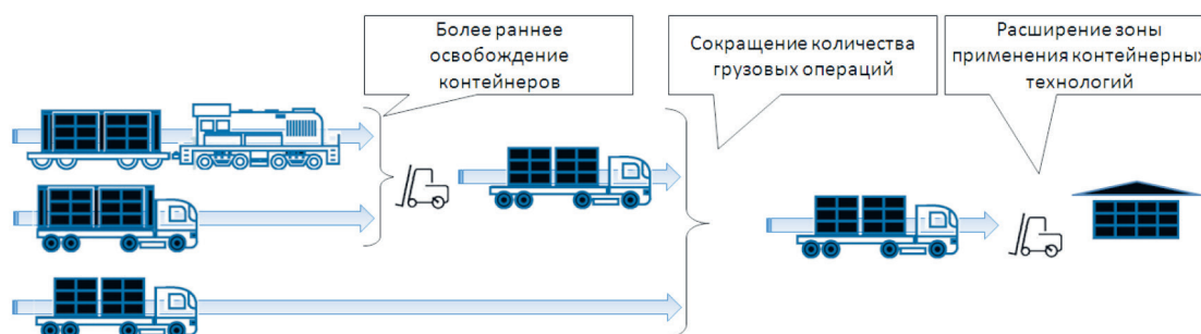
Рис. 2. Перевозка сборных грузов в контейнерах: а — существующая транспортно-технологическая схема; б — применение новых средств укрупнения
