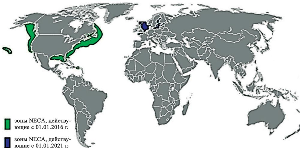
Рис. 2. Распределение зон контроля эмиссии NO<sub>x</sub> (NECA)
