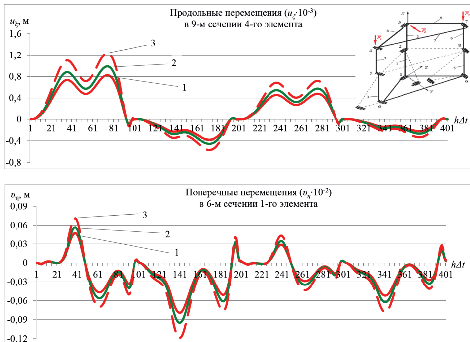
Рис. 5. Изменение продольных и поперечных перемещений в звеньях ППМ при совместном действии сил инерции и сосредоточенной силы F = e^{-\alpha t} \sin \omega t
