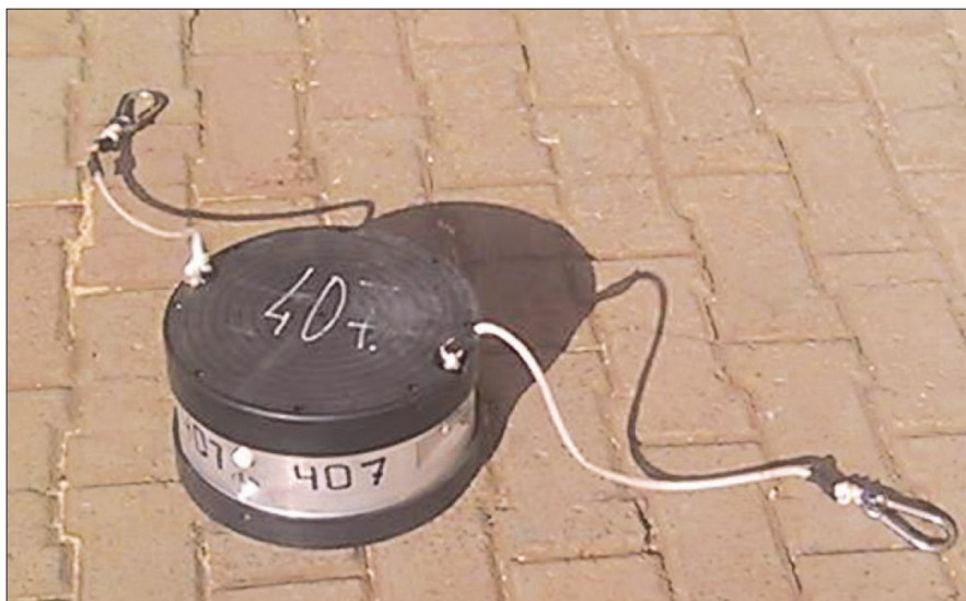
Рис. 1. Один модуль сейсмической донной станции с двумя отвязками с карабинами на концах для подсоединения к общему несущему кабель-тросу
