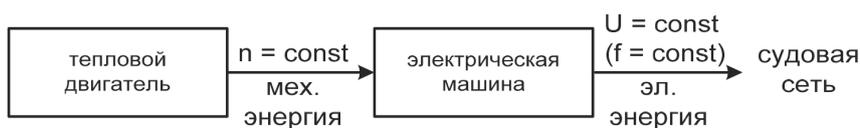
Рис. 2. Функциональная схема традиционного генераторного агрегата
