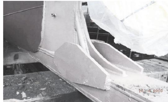
Рис. 9. Фрагменты усиления днища (а) и пятки (б) ахтерштевня судна
