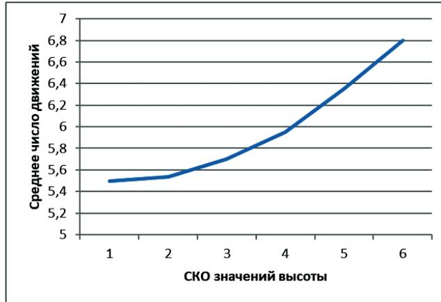
Рис. 2. Зависимость среднего числа движений от разброса высоты складирования,  $h = 10$
