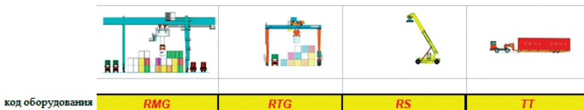
Рис. 5. Примеры технологического оборудования
