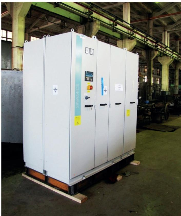
Рис. 5. Управляемый выпрямитель якорной цепи ГЭД
