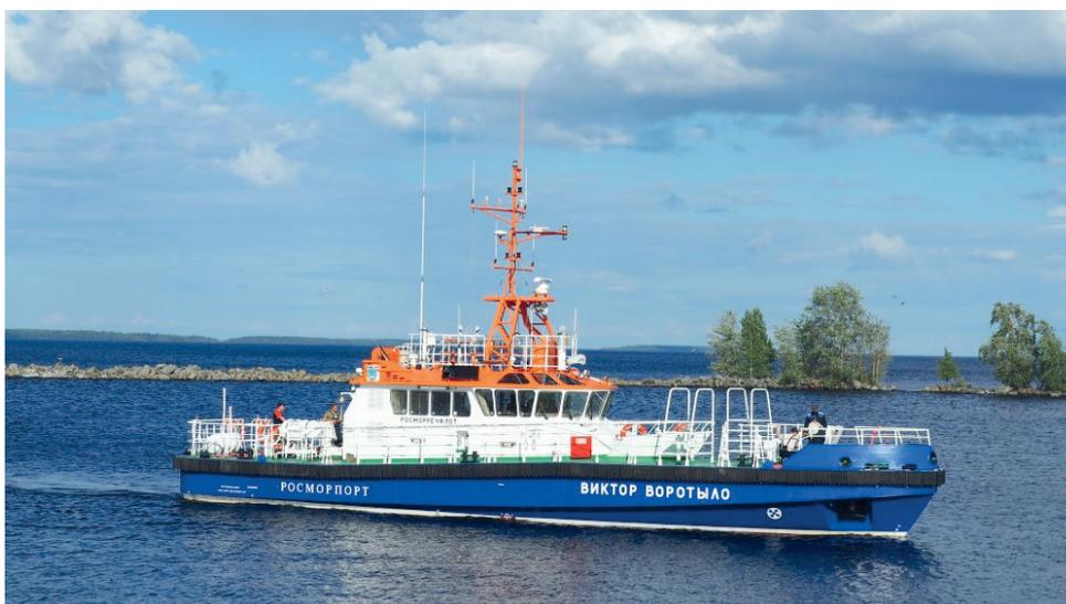
Рис. 4. Рабочий катер с комбинированной пропульсивной установкой (личное фото А. В. Григорьева)
