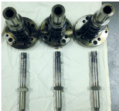
Рис. 4. Состояние плунжерных пар при работе на топливе RMK500 длительностью 2800 мото-ч: а — общий вид плунжерных пар; б — эрозионные пятна на поверхности плунжера
