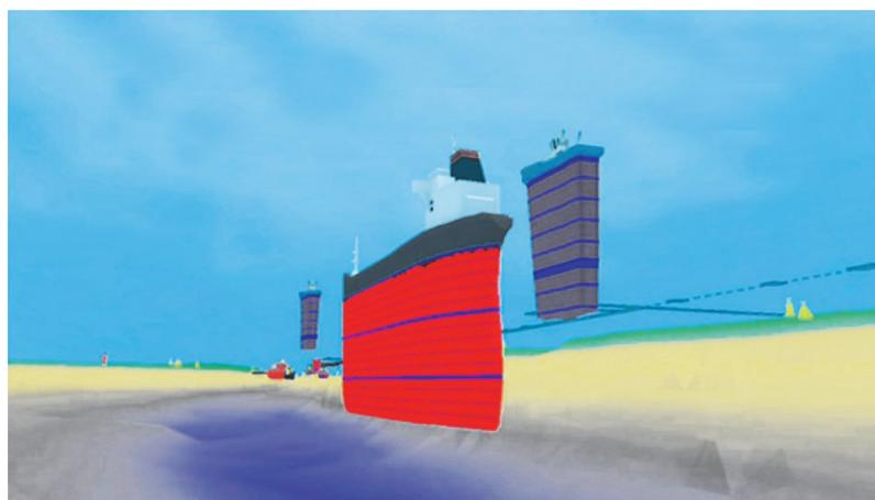
Рис. 3. Пример отображения подводной обстановки на 3D ЭНК при использовании функции вертикального масштабирования: а — общий масштаб; б — крупный масштаб по вертикали
