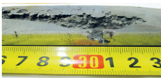
Рис. 13. Макрошлиф зуба колеса открытой передачи с усадочной раковиной
