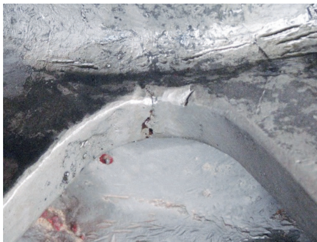
Рис. 12. Пример термической трещины на зубчатом колесе открытой передачи электропривода подъемно-опускных ворот
